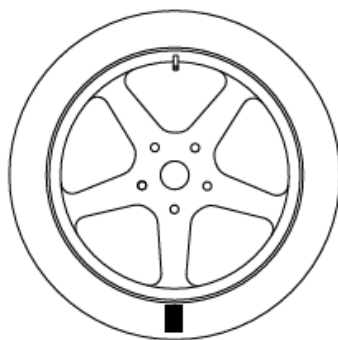
Рис. 5.6 - Маркировка шины на 180° относительно клапана
