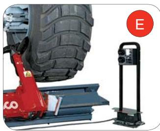
**IT** **CENTRALINA COMANDI:** La macchina è equipaggiata con una centralina comandi movibile a basso voltaggio che ne permette un ideale posizionamento all'interno dell'area di lavoro. Disponibile su richiesta un radiocomando a 16 frequenze programmabili.
