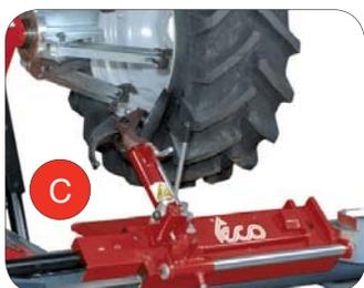
**IT BRACCIO PORTA-UTENSILI:** Sollevamento del braccio e rotazione degli utensili ottenuti manualmente attraverso apposito dispositivo di sbloccaggio. Lo speciale profilo semi-sferico del disco di stallonatura permette una più efficace penetrazione tra cerchio e pneumatico.
