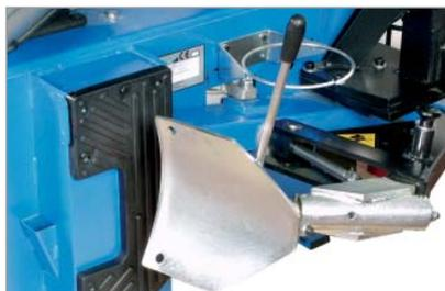
Отжимная лопата специальной формы предохраняет шину и обод от повреждений.
