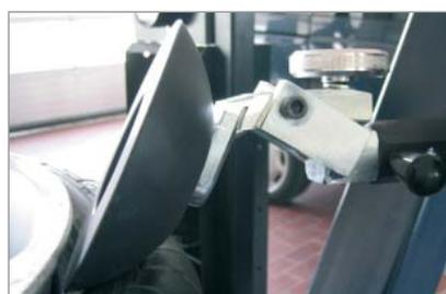
Пластиковый ролик является полезной и эффективной принадлежностью, обеспечивающей бережную обработку шины.
