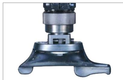
Пластиковая монтажная головка с быстросменным устройством.
